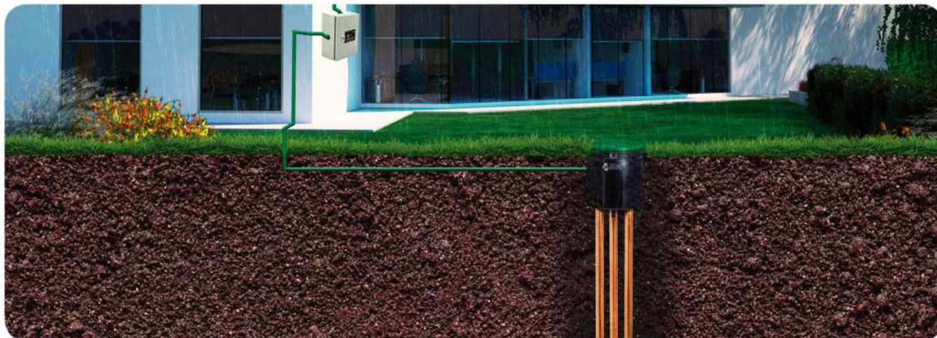
Representación de electrodo TG-100K en puesta a tierra.
